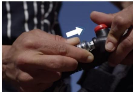
Plie l'Octopus et glisse-le sous la sangle afin de permettre une sortie rapide en cas de nécessité.
